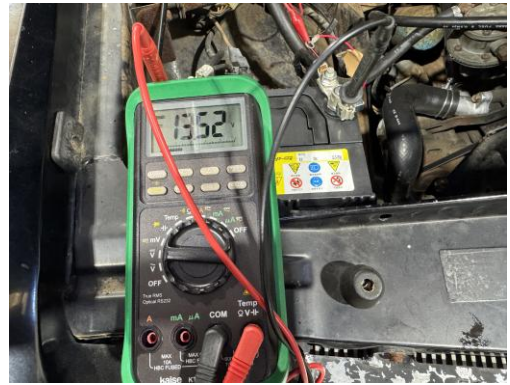
図 16 電圧測定の様子
