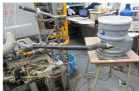
図4 竹粉供給用改造電動散粉機
