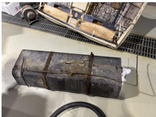
図9 取り外した燃料タンク
