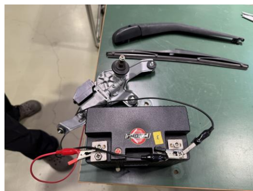
図 4 リア・ワイパー・モーター単体点検の様子
