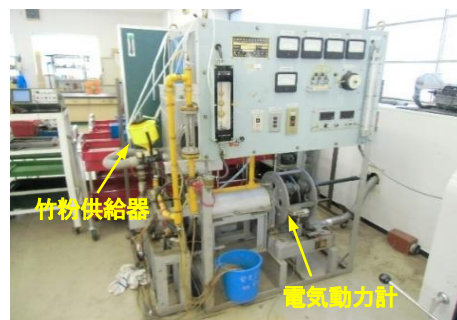
図2 実験装置写真(エンジン性能試験装置全体図)
