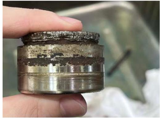
図5 ブレーキのピストン作業前
