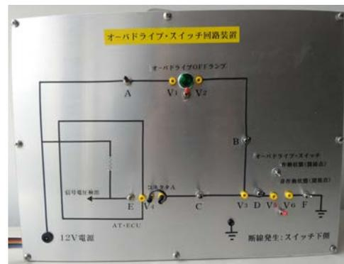
図3 オーバドライブ・スイッチ回路装置のパネル部
