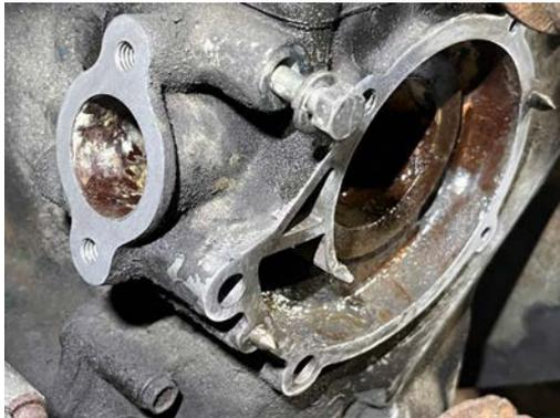
図 12 取り付け面の清掃後の状態
