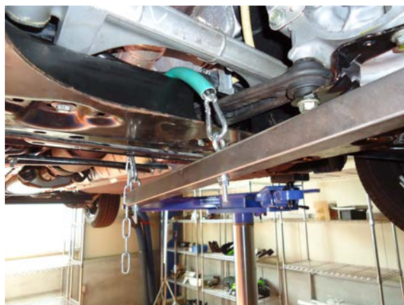
図7 鋼管を吊っている
