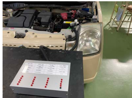
図 14 完成した ECU 測定ボックスと実習車両
