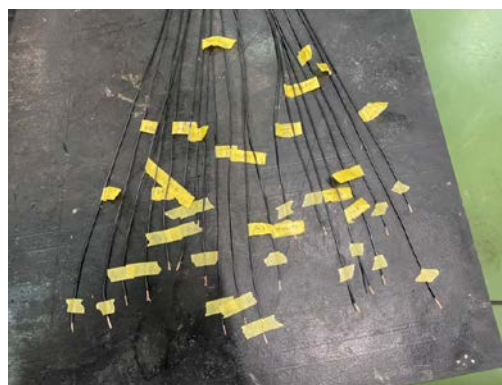
図8 記録と固定をした配線
