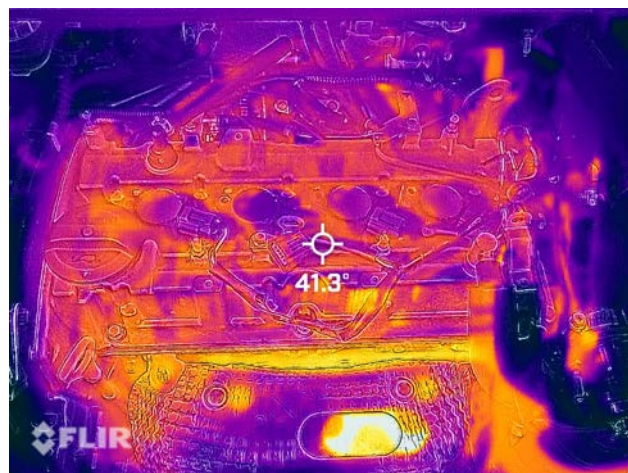
図6 赤外線カメラを使って撮影した画像（断線時）
