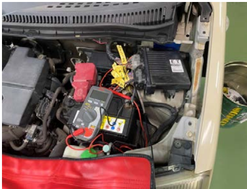
図2 配線にマスキングテープで記録した様子
