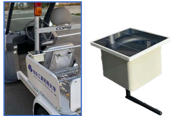
図 4 GPS システムの外観と搭載状況
