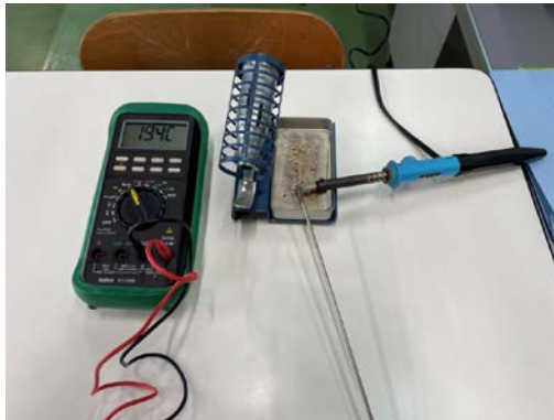
図 11 熱電対を使用した検証の様子
