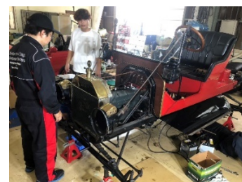
図7. ボデー取り外し作業
