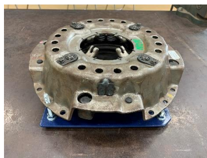
図8 完成した調整台にクラッチカバーを設置した状態
