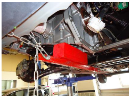
図5 アンダーサポートを取付けた状態
