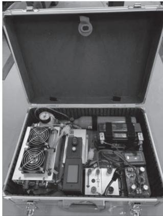
図8 アルミケースに格納した燃料電池システム
