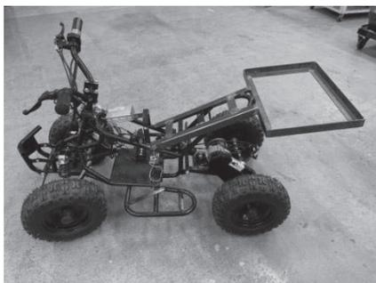
図9 台を取り付けた4輪電動バギー
