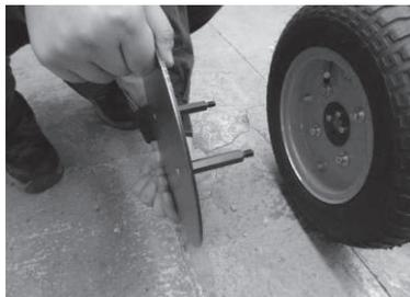
図 5 テスタ取付け用車輪ジグ
