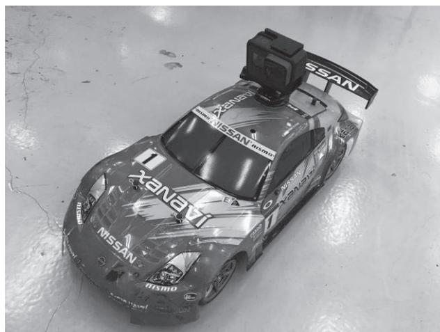
図2 遠隔カメラを搭載したラジコンカーの外観
