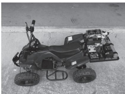
図10 燃料電池システムを搭載した4輪電動バギー
