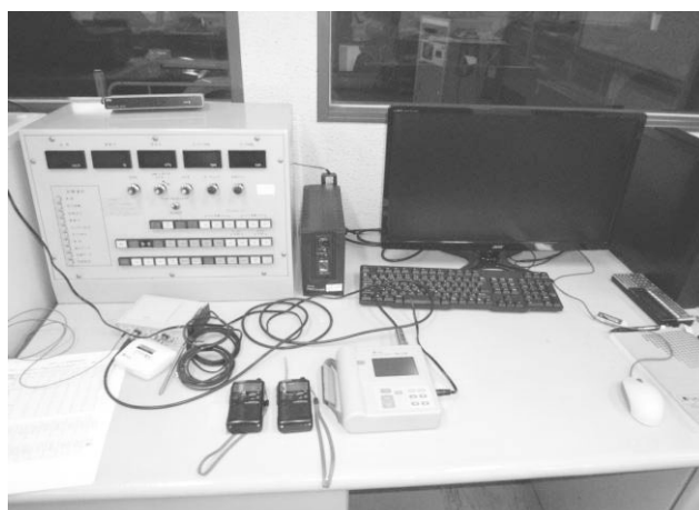
図2 シャシダイナモ・メータ制御部及び振動分析器
