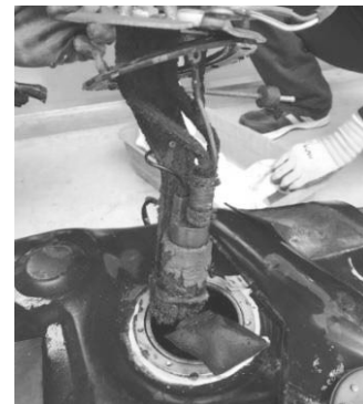
図2 腐食したフューエルポンプ
