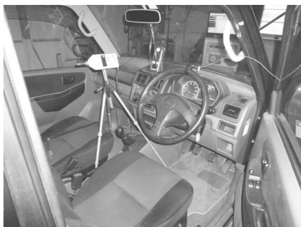
図1 振動・騒音分析器測定場所及び騒音計
