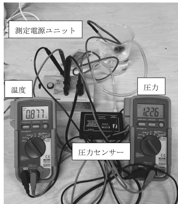
図 2 ボイル・シャルル (冷却) 実験装置
