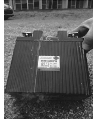
写真 4 破損したバッテリー
