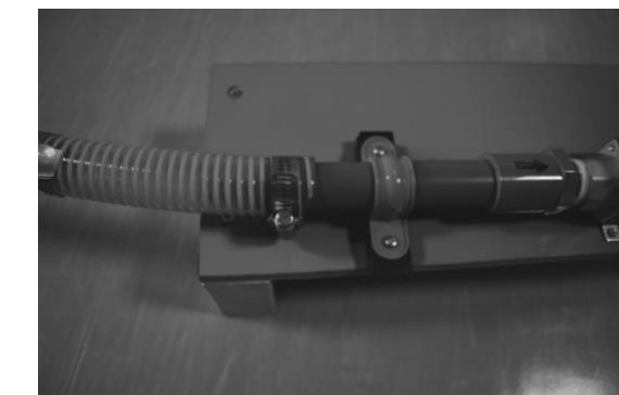
図 9 結束バンドとステンレス製バンドによる接続
