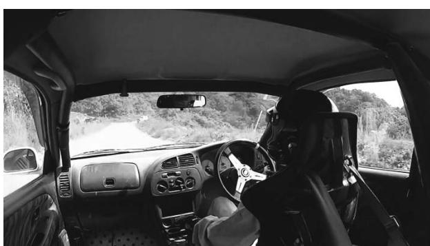
①スタート時はサイドブレーキで車両を停止させ、最適なエンジン回転速度でクラッチミート、サイドブレーキを下ろして発進する。極端なホイールスピンをさせないようにスタートする。
