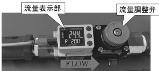
図3 流量計（カルマン流量計）PF3W704S
