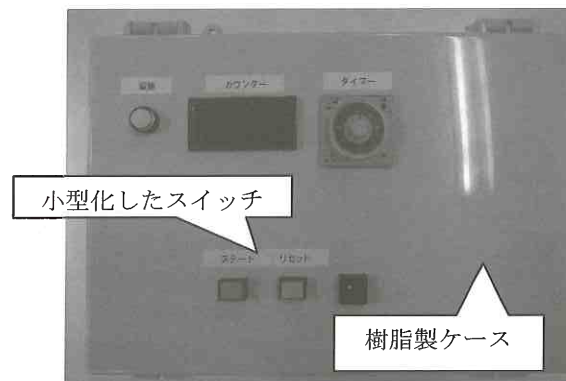
図2 反応速度測定装置外観
