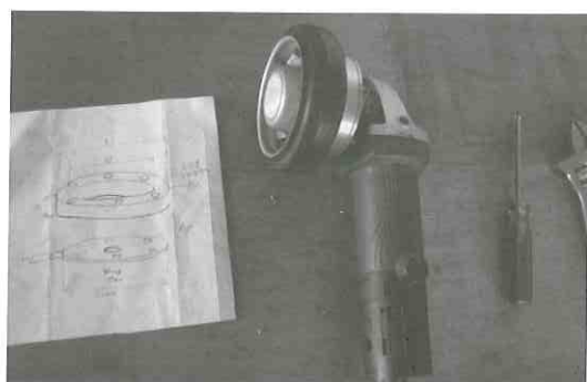
図 21 直径 120mm ゴム付タイヤ装着
