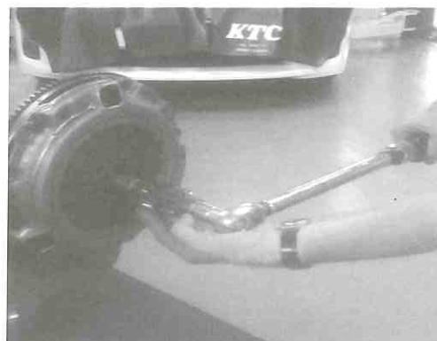
図 11 伝達トルク測定
