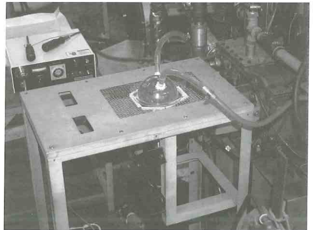
図 4 超音波燃料改質装置の設置と配管
