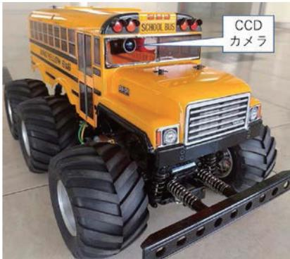
図3 実験車両とカメラ
