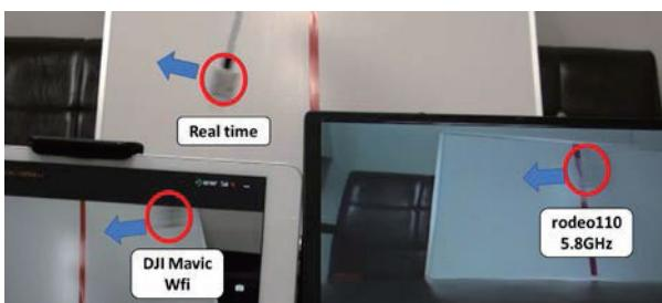
図 4 映像遅延時間測定試験
