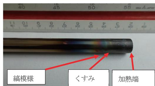
写真2 加熱後の様子（フレームシールド無し）
