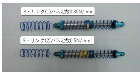
図 2 S・リンクのばね定数設定
