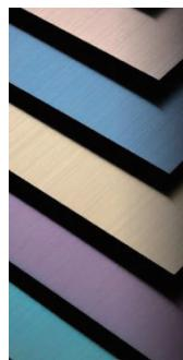
酸化被膜自体は、透明で硬いガラスのような性質を持ち、非常に薄い膜厚（数十 nm
