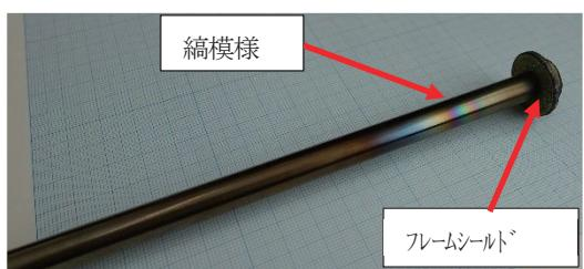
写真3 加熱後の様子（フレームシールド付き）
