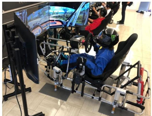
図2 7軸レーシングシミュレータ
