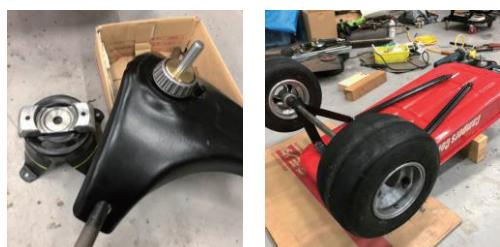
図11 操舵機構と車軸周り改造
