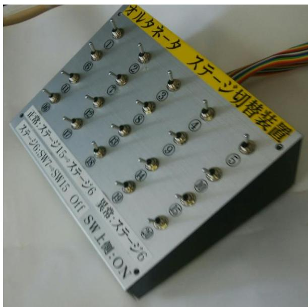
図4 ステージ切替装置
