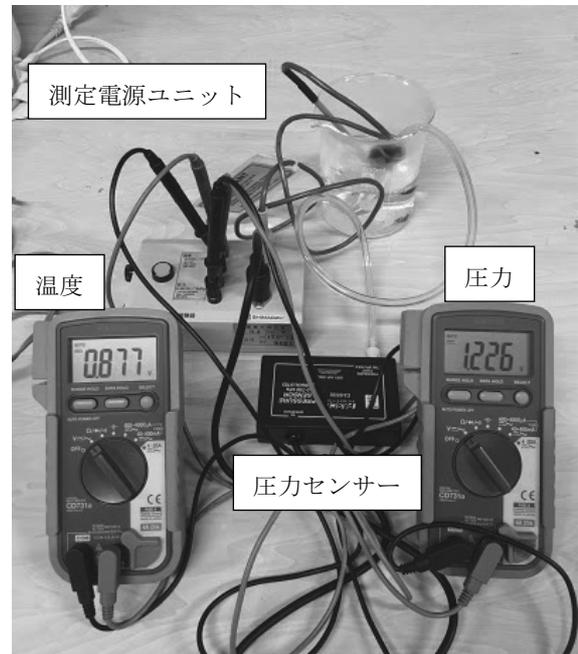
図2 ボイル・シャルル（冷却）実験装置
