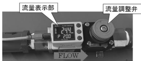
図3 流量計 (カルマン流量計) PF3W704S
