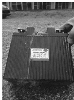
写真 4 破損したバッテリー
