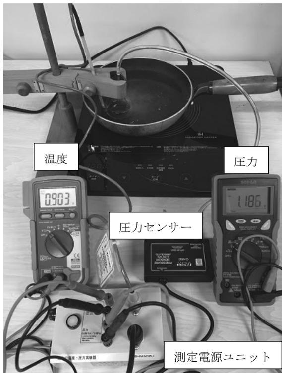
図1 ボイル・シャルル（加熱）実験装置
