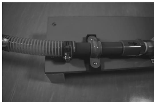
図4 結束バンドとステンレス製バンドによる接続
