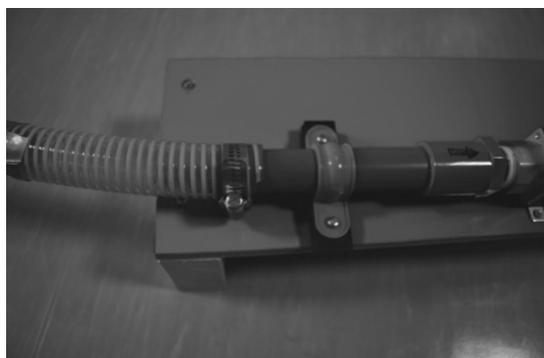
ホースについては図 10 に示す、十川産業製 MEGA サンプレーホース SB25 最高使用圧力 1Mpa 最小曲げ半径 100mm 軟質ポリ塩化ビニールにポリエステル糸を格子状に挟んだ上に軟質塩化ビニールで覆った構造のホースを選定した。またホースにガイドラインが印されていることで捻じれが把握しやすい。
